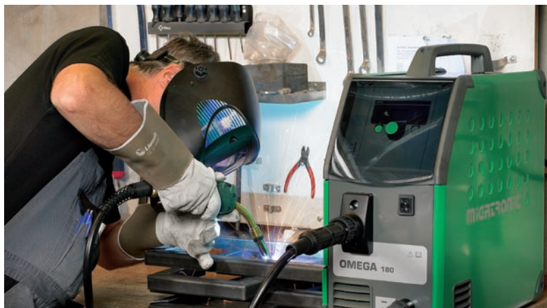
Svařování profilů pro konstrukci kovového nábytku
