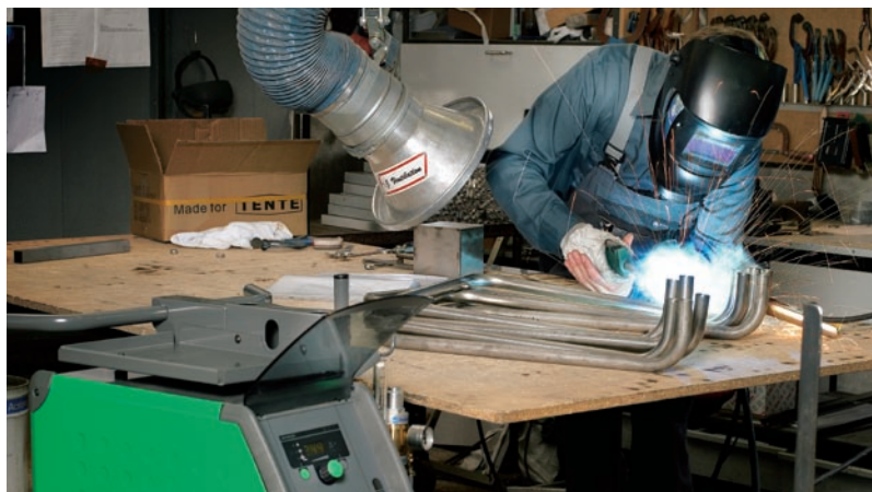
Výroba armatur pro potravinářský průmysl metodou DUO Plus™ z nerezavějící oceli
