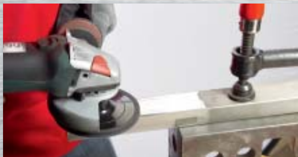
Příprava k leštění: Příprava materiálu k leštění pyramidovým brusným kotoučem Metabo se suchým zipem.
