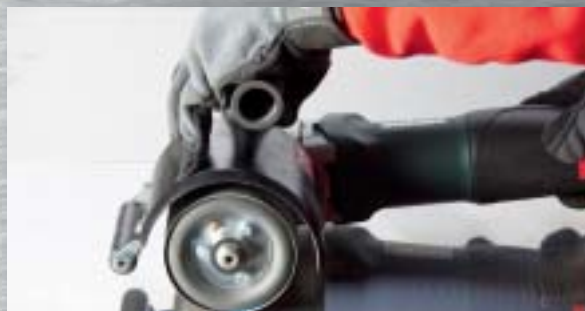
Příprava k leštění: Pryžovým válcem a pyramidovým brusným pásem Metabo zrnitosti P 2000 (A6).
