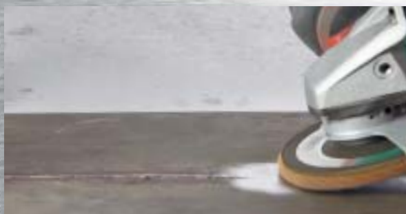
Vybrušování svárů: S úhlovou bruskou Inox a kombinovaným "hrubým" lamelovým brusným kotoučem.
