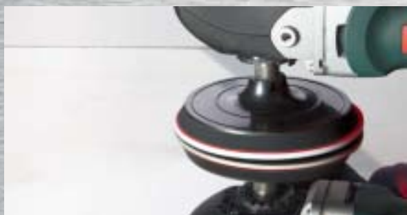
Leštění do vysokého lesku: Úhlová leštička PE 12-175 s plstěným kotoučem a modrou lešticí pastou k leštění do vysokého lesku.
