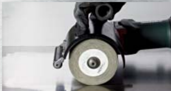
Satinační výbrus: Perfektní povrchy bez škrábanců díky satinačnímu výbrusu pryžovým válcem (satinování).
