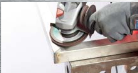
Vybrušování jemných svárů: S úhlovou bruskou Inox a kombinovaným "středním" lamelovým brusným kotoučem.
