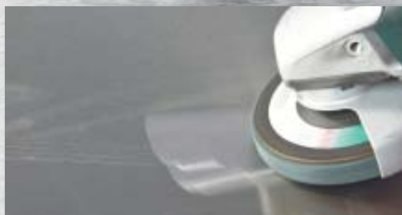
Odstranění škrábanců: S úhlovou bruskou Inox a rounovým kompaktním kotoučem.
