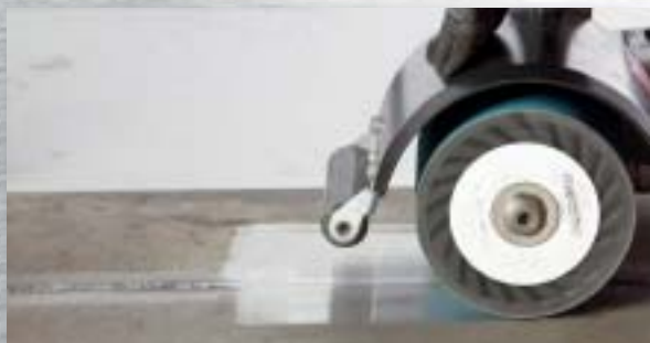
Hrubé broušení: Expanzní válec a hrubá brusná pouzdra zrnitosti P 60, P 80 nebo P 120 pro hrubé broušení materiálu.
